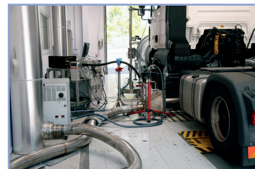
Banc d'essai des silencieux FAP DINEX, qualité origine 1ère monte
